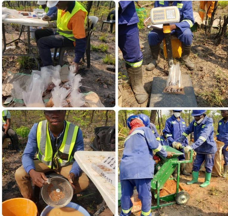
**Figure 25 Image montrant les techniciens à la machine de forage RC (cartage, pesage, lavage et étiquetage)**
