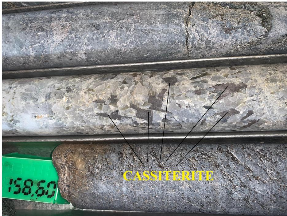
**Figure 22 Minéralisation en cassitérite dans le forage DDC-09 dans la partie greizenifiée**
