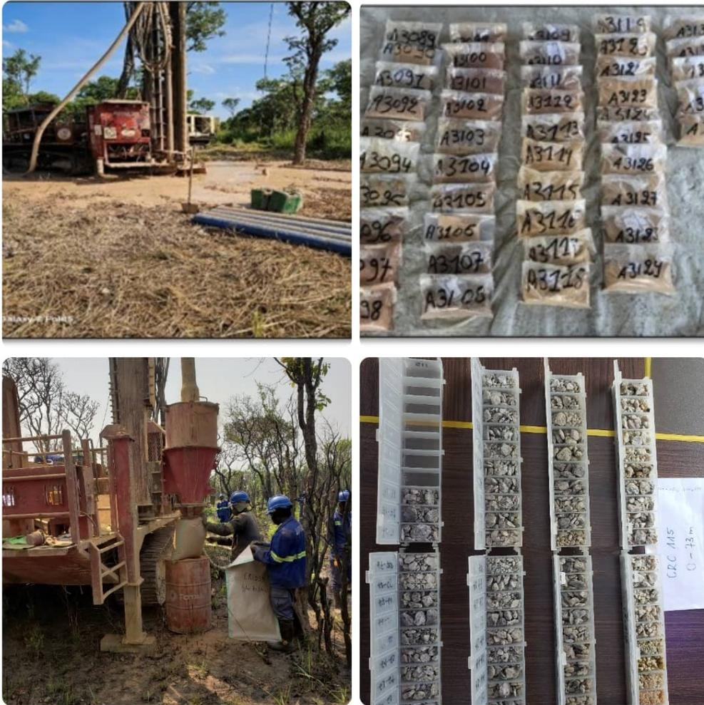
Figure 42 Machine de forage RC avec les échantillons et le cheap tray
