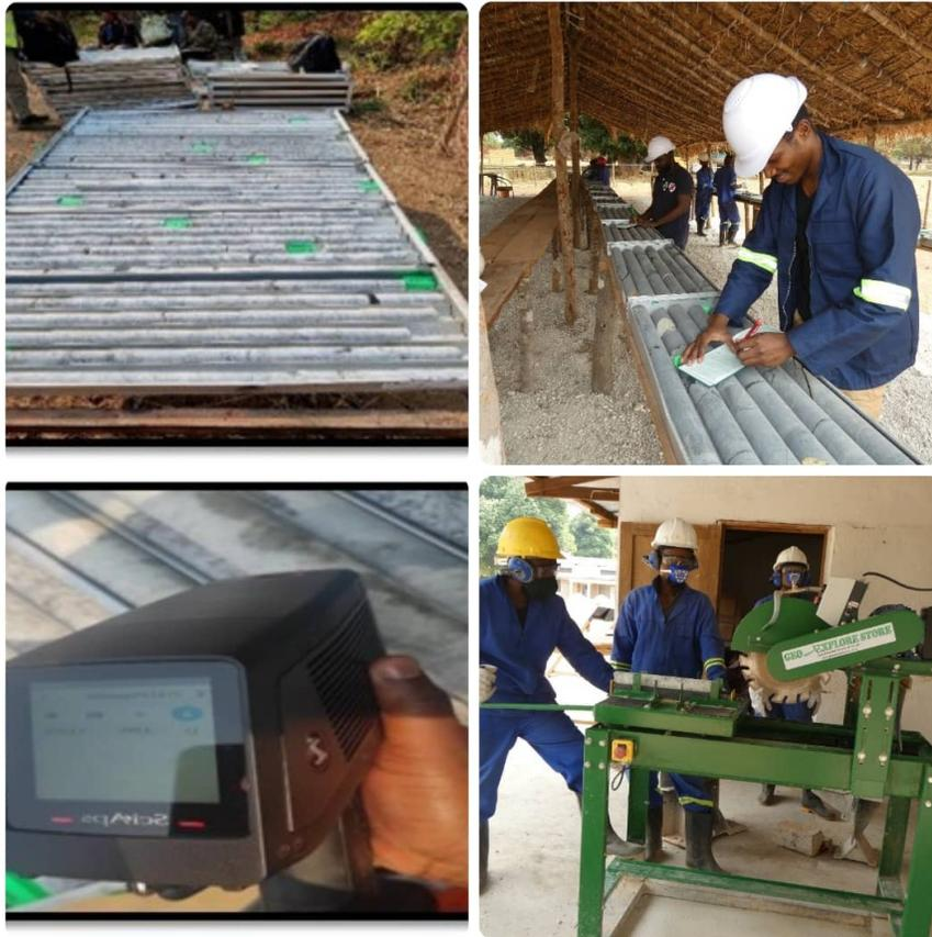
**Figure 19** Image montrant le core processing des géologues et techniciens au core cutting
