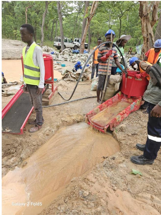
**Figure 33 Lavage des échantillons de forage avec la centrifugeuse**
