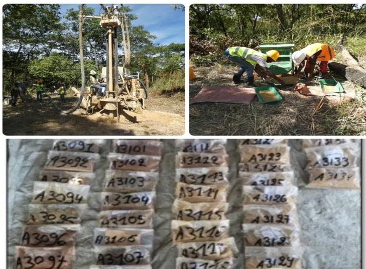
**Figure 24** Image montrant de la machine de forage RC(TTLX) avec le Techniciens géologues en train de faire le cartage et étiquetage des échantillons avant l'expédition au laboratoire
